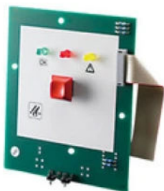
Zusatzmodul RWA-Bedienstelle TRZ/RBH-Basic
