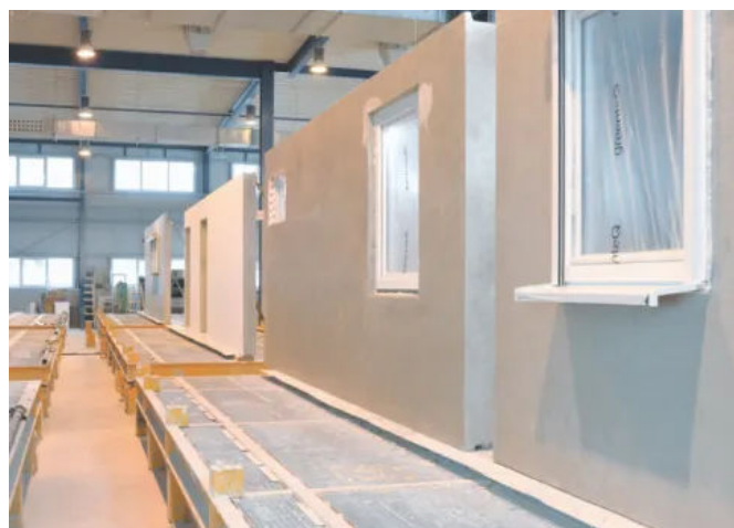
Vorgefertigte Wand - Kalksteinwandtafeln
