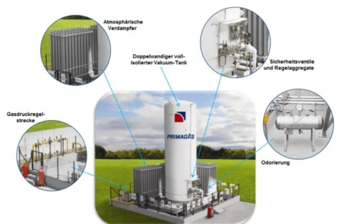
Anlagenkomponenten von LNG
