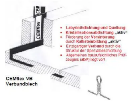
Fugenblech CEMflex® Einbaubeispiel
