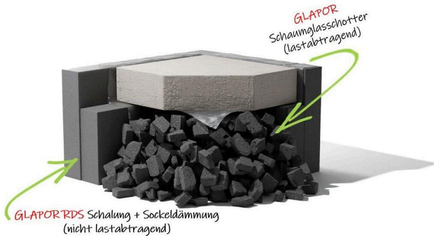
GLAPOR Kombi-Perimetersystem aus RDS-Schalungselementen und lastabtragendem Schaumglasschotter für Gründungs- und Bodenplatten. Das System ist kunststofffrei, extrem druckfest, brandsicher und nagetierbeständig. Gründungs- und Sockelbereiche sind mit dem GLAPOR RDS-Kombisystem schnell und mit weniger Schalungsaufwand nachhaltig realisierbar.
