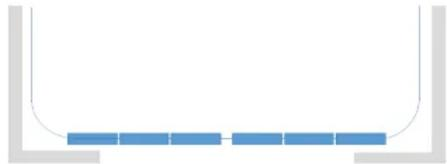
Durch die wahlweise seitlich innen oder außen an der Hangar-Seitenwand entlanggeführten Torelemente kann sich dieses Prinzip an die vorhandenen Gegebenheiten anpassen.
