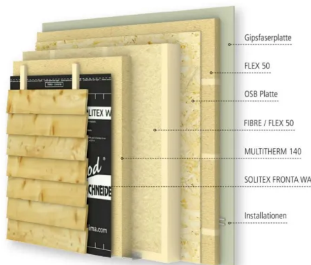
Außenwandkonstruktion mit best wood MULTITHERM 140 und best wood FLEX 50
