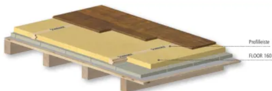
Bodendämmung mit best wood FLOOR 160 mit Einlegeleiste
