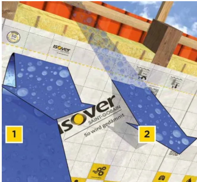
Die Funktion der Vario® Klimamembranen
