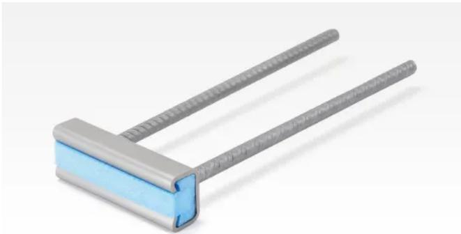
Die JORDAHL® Geländerbefestigungsschienen JGB garantieren die haltbare Befestigung von Geländern und Fassadenelementen an der Stirnseite von Betonplatten, wie z. B. Balkonen. Das System besteht aus Schienenprofilen mit langen Bewehrungsstäben, die auch in dünne Betonplatten einbetoniert werden können, und den zugehörigen JORDAHL® Schrauben. Mit der daraus entstehenden, verstellbaren Verbindung werden die Anforderungen verschiedenster Geländertypen abgedeckt.
