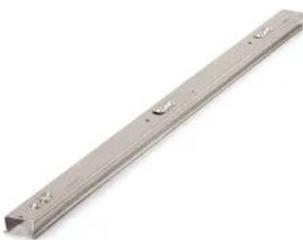
Die JORDAHL® Maueranschlussschienen Kt in Verbindung gewährleisten in Verbindung mit den passenden Maueranschlussankern den dauerhaften Anschluss von Mauerwerk an angrenzende Bauteile. Die Maueranschlussschienen stellen zuverlässige Verbindungen zu Stahlbeton, Holz und Stahl her. Durch ihre geringe Profilhöhe sind sie auch für den Einbau in stark bewehrten Betonbauteilen geeignet.
