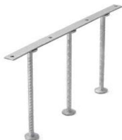
Die JORDAHL® Durchstanzbewehrung JDA ist bestens für die Verstärkung von Fundamenten in Wohn- und Bürogebäuden oder speziell für den Einsatz in Elementdecken geeignet. Durch ihren Aufbau aus Doppelkopfkankern kann sie hohe Stützkräfte in Flachdecken mit geringem Schalungs- sowie Bewehrungsaufwand übertragen. So schützt sie zuverlässig vor Durchstanzversagen.
