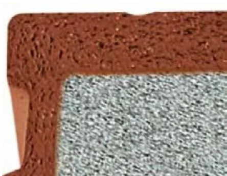
Deutlich sichtbar ist die poröse Struktur von Ziegelscherben und Perlitfüllung.
