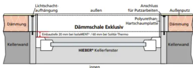
Einbauschema Thermo-Dämmschale Exklusiv
