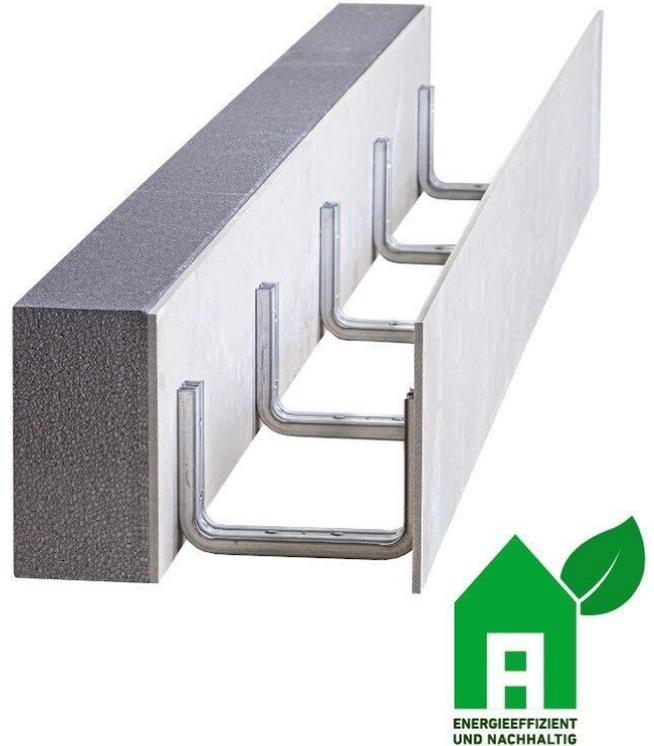
MAKORING Ringbalkenschalungen und Überzugschalungen mit Wärmedämmung tragen zur Steigerung der Energieeffizienz und Senkung der Betriebskosten des Gebäudes bei. Aufkaschierte Wärmedämmungen vermeiden umständliche Dämmösungen nach den Betonierarbeiten und reduzieren Wärmebrücken. Die Varianten mit Schalungsplatten in Baustoffklasse A1 erfüllen hohe Brandschutzanforderungen.
