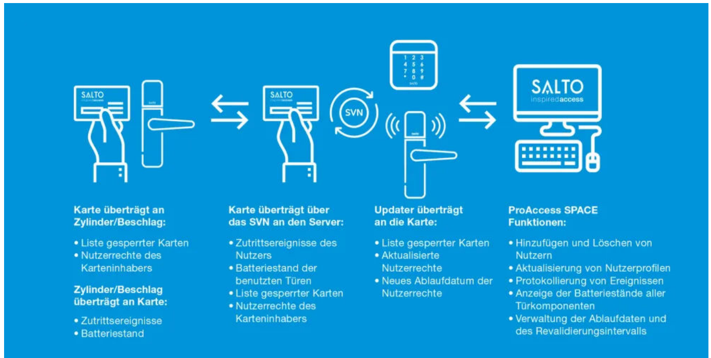
Funktionsweise des Salto Virtual Network (SVN)
