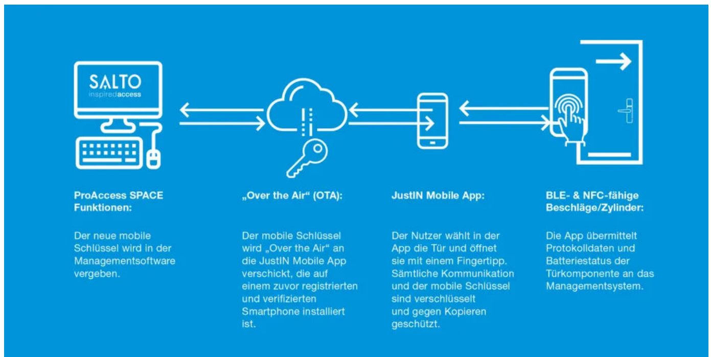
Funktionsweise der Smartphone-basierten Zutrittslösung JustIN Mobile
