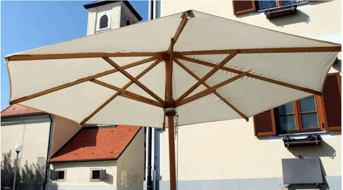
Für alle Holz-Sonnenschirme werden ausgesuchte FSC-zertifizierte Hölzer aus der EU verwendet. Die Masten haben einen Durchmesser von 58 mm, die Maße der Streben sind 36 x 18 mm, damit sind sie sehr stabil. Das Öffnen erfolgt immer über einen 2-fach Flaschenzug, je nach Sonnenschirm Typ ergibt sich eine Tischfreiheit von 75 cm.
