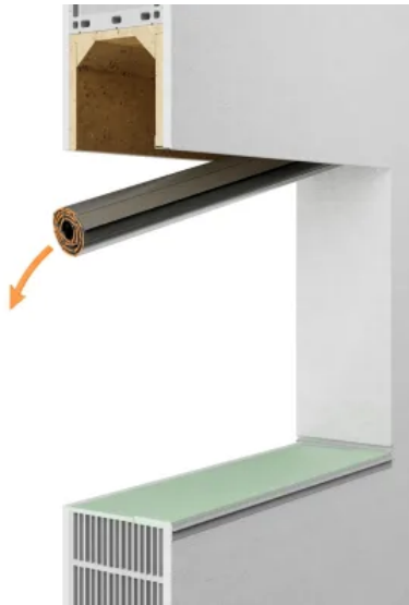
Alten Rollladen aus Kasten entfernen.
