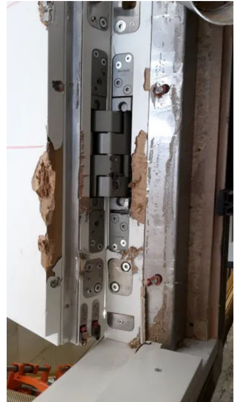
Das „PIVOTA® DXS 300 3-D“ weist eine Tragfähigkeit von 350 Kilogramm pro Paar auf und besteht ausschließlich aus Stahl. Dadurch erreicht das Band die Einbruchhemmung der Widerstandsklasse RC4. Das Bild zeigt das Band nach bestandener Einbruchprüfung. Foto: Huber Form Schreinerei GmbH, Triftern-Neukirchen
