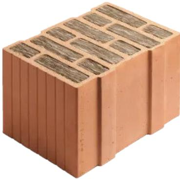
Die Lücking ThermoPlan® MZ65 und MZ70 kombinieren gebrannten Ton mit Mineralfaserdämmstoff als Dämmkern. Mineralfaserdämmstoff gehört zu den meistgenutzten Materialien für die Wärme- und Schalldämmung. Der eingesetzte Mineralfaserdämmstoff ist nicht brennbar, wasserabweisend, aber dampfdurchlässig, alterungsbeständig und dämmt nicht nur gegen Hitze und Kälte, sondern auch gegen Lärm.
