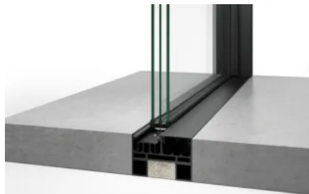
flow: Der Schiebeflügel gleitet auf den im Bodenprofil eingelassenen, kugelgelagerten Laufrollen. Diese Ausführungsart ermöglicht eine flache, 17 mm tiefe Schwelle.
