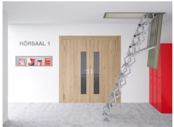
Die Scherentreppen Stahl Luke EI2 30 ist für den Einbau in Stahlbetondecken ab 180 mm, die der Feuerwiderstandsklasse EI2 30 angehören. Der Lukenkasten ist komplett aus Stahlblech mit umlaufenden Profilrahmen gefertigt. Der Lukendeckel hat eine innen liegende Isolierung und eine umlaufende Zweifach-Dichtung.
