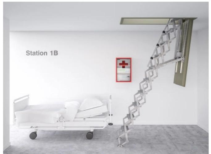
Die Scherentreppen Stahlluke Elektro EI2 30 ist für den Einbau in Stahlbetondecken ab 180 mm, die der Feuerwiderstandsklasse F30 angehören. Der Lukenkasten ist komplett aus Stahlblech mit umlaufenden Profilrahmen gefertigt. Der Lukendeckel hat eine innen liegende Isolierung und umlaufend eine zweifache Dichtung.
