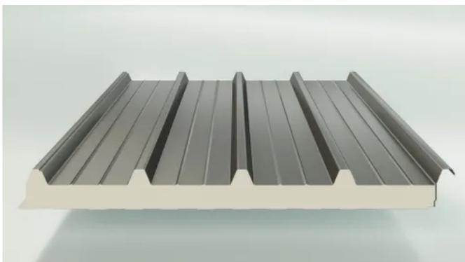
Das Sandwichpaneel Isocop zeichnet sich durch seine profilierte Außen- und Innenschale aus Stahlblech und seiner Dämmung aus Polyurethanschaum aus. Die Befestigung ist sichtbar und erfolgt mit speziellen Metallkappen mit Dichtung.
