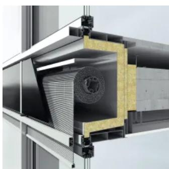
Die komplett fassadenintegrierte Verschattungslösung Schüco CSB reduziert an sonnenreichen Tagen den Wärmeeintrag in das Gebäude, bei gleichzeitiger hoher Transparenz von 23 Prozent Außenbezug selbst bei geschlossenem Behang.
