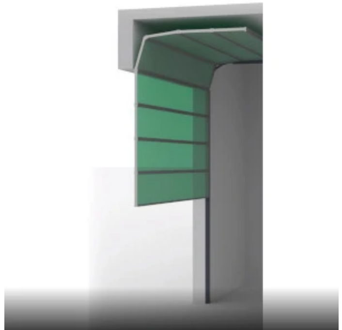
Das Öffnungsprinzip: Beim Öffnen werden die Torsektionen unter der Decke umgelenkt und ins Halleninnere geführt. Dafür reichen bereits 350 mm Sturzhöhe aus.
