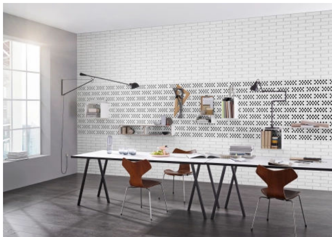
Büro: KS Verblender, teils hochkant mit sichtbarer Lochung (Bild: Thomas Popinger / KS-ORIGINAL GMBH)
