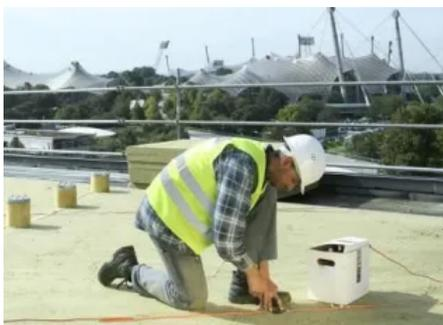
smartex® mx: Ein Raster von Sensoren misst den Isolationswiderstand der Abdichtung und erlaubt eine punktgenaue Leckagenortung.
