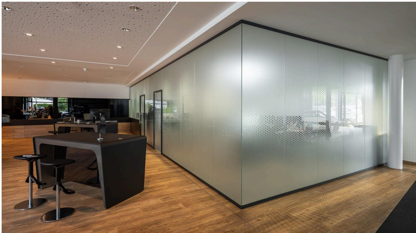
Das flexible, rahmenlose Ganzglas-Trennwandsystem Vista ist ausschließlich von filigranen, umlaufenden Anschlussprofilen mit einer Abmessung von 45x25mm eingefasst. Die Verglasungen werden ohne vertikale Stützen direkt stumpf gestoßen und durch eine Reinacrylat-Trockendichtung miteinander verbunden. Das Trennwandsystem entspricht allen aktuellen technischen Vorgaben und Nachhaltigkeitsstandards. Eine Wiederverwendbarkeit sowie sortenreines Recycling sind mit Blick auf zirkuläres Bauen möglich.
