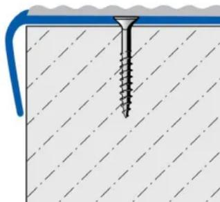
TREDSAFE-Treppenstufenprofile mit Stoßkanten für saubere Belagsübergänge / dünne Belagsarten
