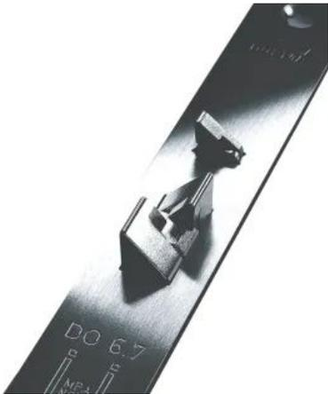
SVZ 6000 Schlösser verriegeln Türen selbsttätig nach jedem Schließen. Der automatische Riegelausschluss von 20 mm gewährleistet, dass die Tür jederzeit versicherungstechnisch verschlossen ist. Durch die zusätzliche Arretierung der Kreuzfalle wird eine Zweipunktverriegelung erreicht, welche erhöhte Sicherheit bietet. Die Türdrücker sind zeitgleich ein- oder ausgekuppelt, eine mechanische Öffnung über den Profilylinder ist jederzeit möglich.
