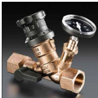
„Aquastrom VT“ Thermostatventil aus Rotguss mit voreinstellbarem Zirkulationsvolumenstrom im Betriebsbereich für Zirkulationsleitungen PN 16.
