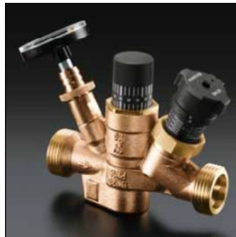
„Aquastrom T plus“ Thermostatventil aus Rotguss mit Voreinstellung für den hydraulischen Abgleich im Anfahrbetrieb in Zirkulationsleitungen PN 16.
