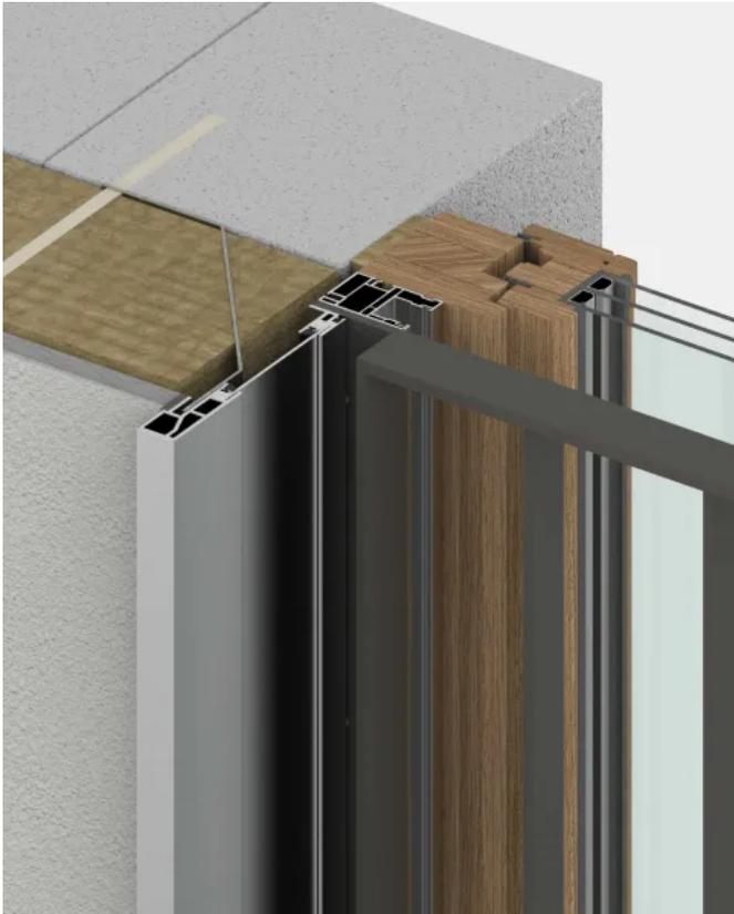
Konstruktionsdetail Zargensystem COVER in Kombination mit Glas-Absturzicherung
