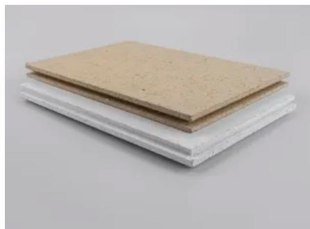
Die Amroc-Verlegeplatte als Trockenestrich mit beidseitig geschliffener Oberfläche und umlaufender Nut-Feder-Profilierung ist druckfest, schalldämmend und begehfreundlich. Die Verlegung kann schwimmend erfolgen, wobei die Platten immer an den profilierten Kanten miteinander verleimt werden müssen. Eine Filzunterlage (oder ähnliches) als Trittschalldämmung erhöht den Begehkomfort. Desweitern ist eine Dampfdiffusionssperre unter den Verlegeplatten aufzubringen.
