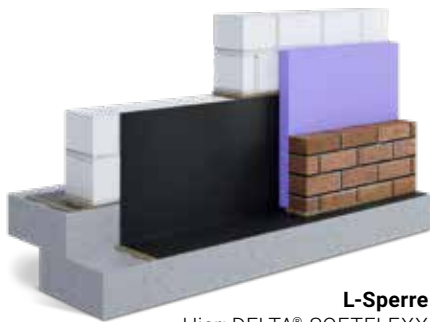
Horizontalsperre Hier: DELTA®-MAUERWERKSSPERRE
