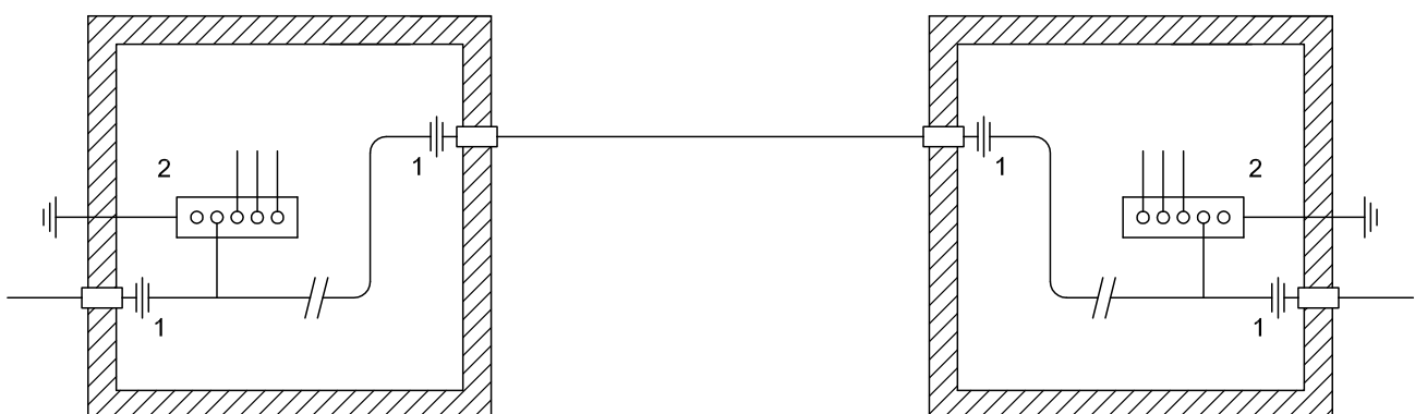
Abbildung 7: Potenzialausgleich bei erdverlegten metallenen Rohrleitungen
