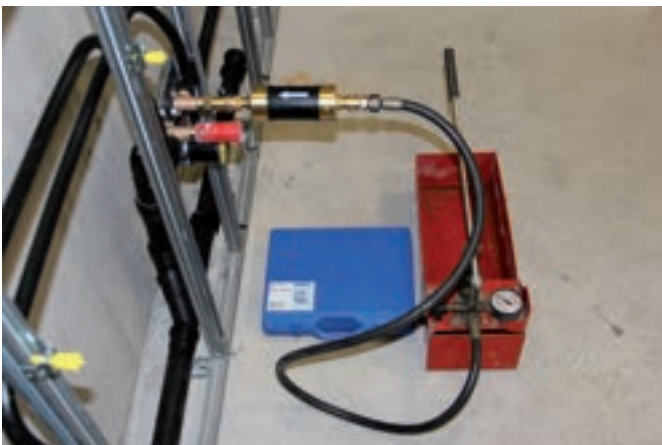
Abbildung 92: Prüfpumpe in Verbindung mit Geberit Hygienefilter
