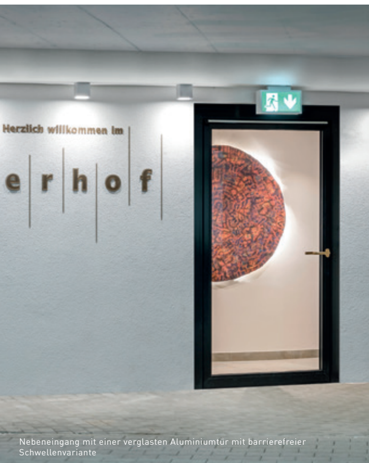
Rohrrahmentüren NovoFire® Thermo EI, 30 C5 für die Außenanwendung mit stabilen Aluminiumprofilen (4 mm Wandstärke), thermisch getrenntem Profil-System und einem Wärmedurchgangskoeffizienten von U_D = 1,7 - 2,2 \text{ W/m}^2\text{K}
