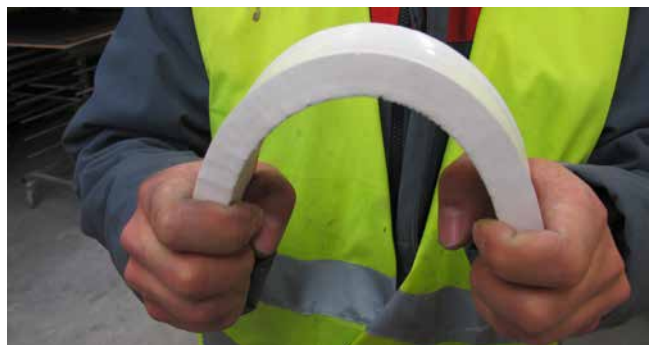
Das kapillardichte Sopro PU-FlächenDicht ist hoch flexibel.
