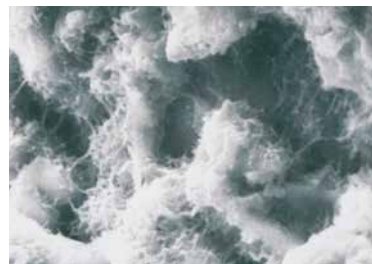
Sopro AnhydritKleber flexibel: keine Ettringitbildung in der Grenzflächenzone zum Calciumsulfatestrich (Anhydritestrich).
