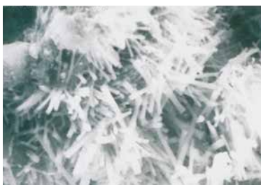
Ettringitbildung bei normalem Dünnbettmörtel in der Grenzflächenzone zum Calciumsulfatestrich (Anhydritestrich).
