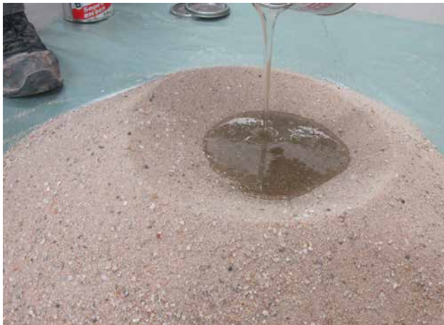
Die Komponenten eines kunstharzgebundenen Estrichs bestehen aus einem feuergetrockneten Quarzsand und einem Bauharz (Sopro BauHarz + Sopro EpoxiEstrichKorn).
