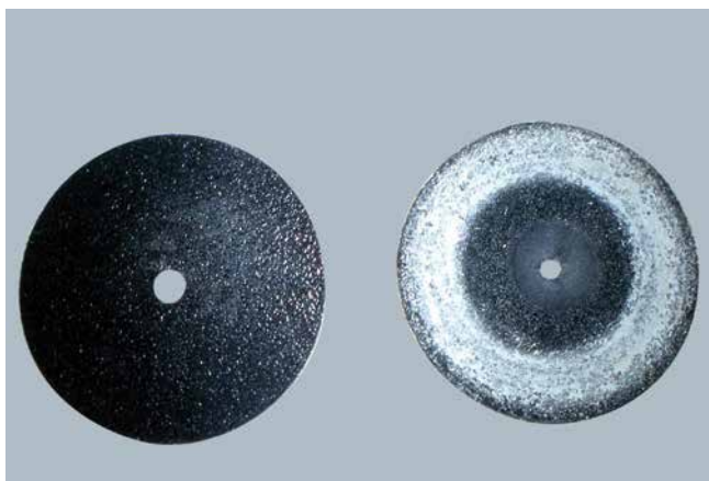
Anschleifen der calciumsulfatgebundenen Estrichoberfläche mit grobem Sandpapier.
